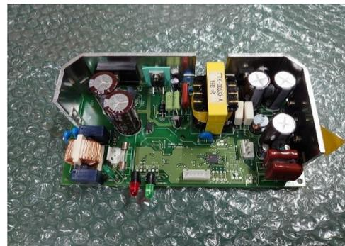
基板を非静電対応のエアマットに直接置いている。
