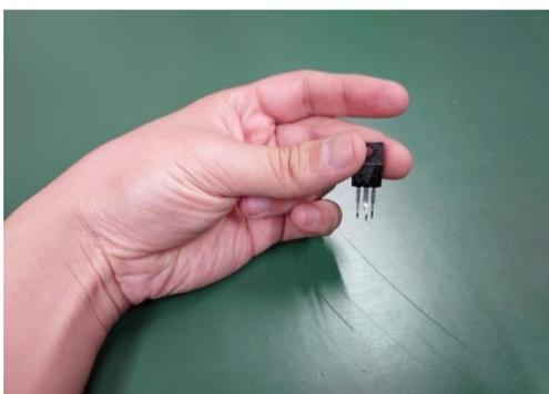
リストバンドを付けずに電子部品を取扱っている。
